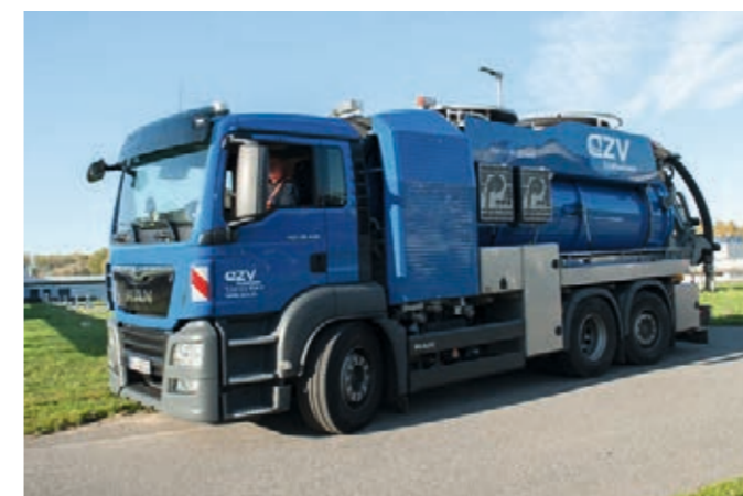
GRÖSSTES FAHRZEUG DES AZV SÜDHOLSTEIN: DER SAUG- UND SPÜLWAGEN
