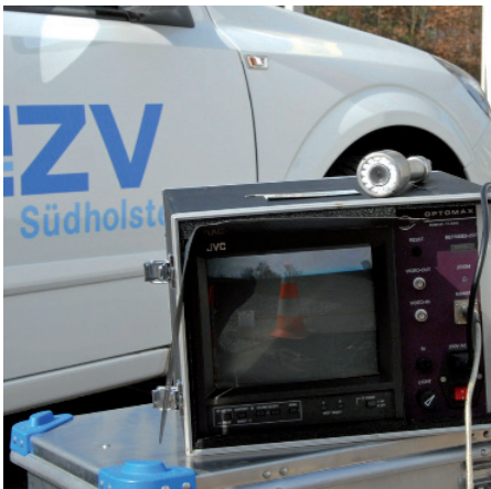
Abb. 6: Kontrolle der Kameraführung während der Inspektion
